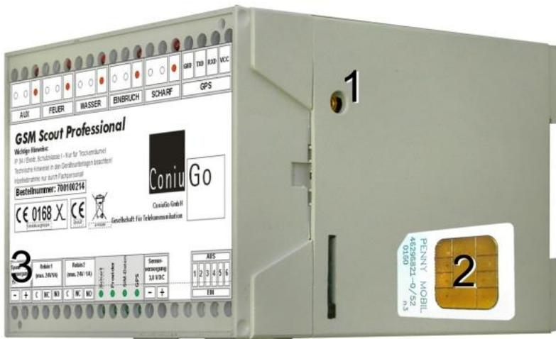
Mit dem Einlegen der SIM-Karte, dem Anschließen der Antenne und der Spannungsversorgung ist das Gerät betriebsbereit:
