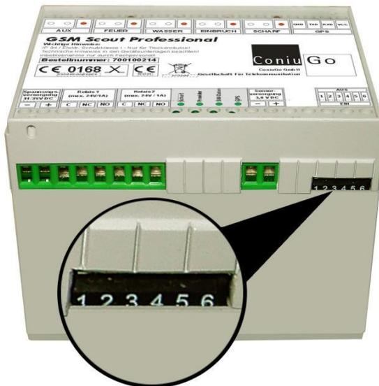
Das Abspeichern der Position im Rufnummernverzeichnis erfolgt entweder manuell in dem man **Schalter 1 der Schaltereinheit** an der rechten Unterseite des Geräts (Abb.3) kurz auf „Ein“ und dann wieder auf „Aus“ schaltet, oder **automatisch über das Scharfschalten** (direkt am Gerät oder über eine entsprechende SMS).
