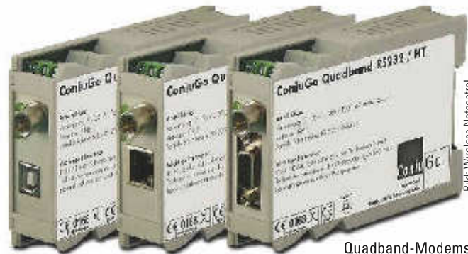
Quadband-Modems sind auch als Hutschienengerät verfügbar
