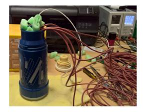
Die mit dieser Messanordnung erzielten Messergebnisse sind in der nachfolgend gezeigten Tabelle zusammengefasst. Hierbei wurden neben den Temperaturwerten, die das GO analog in PT1000- Modul übermittelt auch mit einem Ohmmeter die Widerstandswerte der PT 1000- Sensoren gemessen. Obwohl – wie bereits gesagt – diese Messungen für belastbare Aussagen zu ungenau sind, sind die Widerstandsmessungen dennoch als Anhaltspunkte und als Vergleichswerte nützlich.
