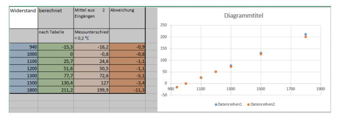
PT1000- Modul gemessenen Werte stimmen bis ca. 50 °C gut überein. Es ist in der weiteren Untersuchung mit echten Medien unterschiedlicher Temperatur insbesondere zu prüfen, wie die Messergebnisse im Temperaturbereich um 80 °C aussehen, da in diesem Temperaturbereich eine relativ hohe Abweichung vom Erwartungswert festgestellt wurde.
