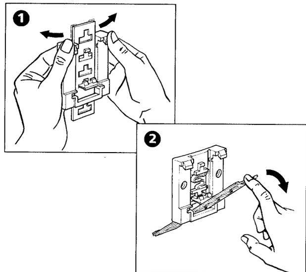
Die Montage des Tragschienenhalters erfolgt an der Gehäuserückseite mit Hilfe von zwei Bohrungen (**Durchmesser 2,5 mm**). Der **Abstand der Bohrungen** beträgt **35 mm**.
